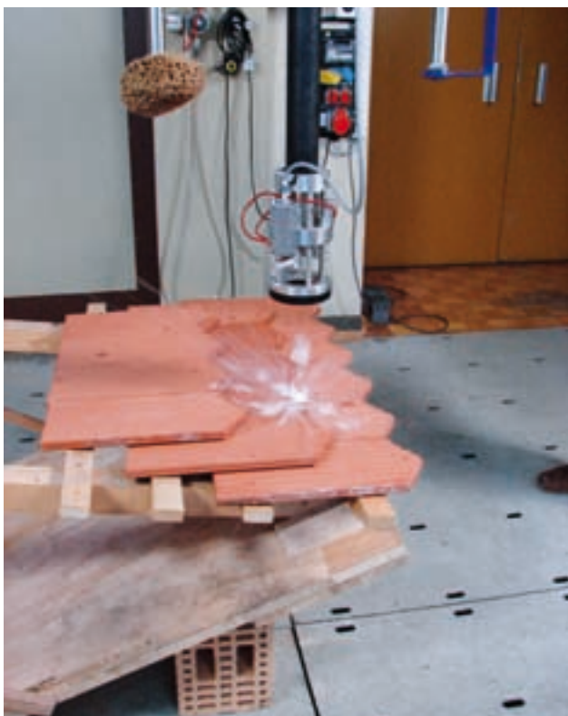
Abbildung 6.19: Hagelkanone mit aufgebauten Ziegeln, Foto Empa.
