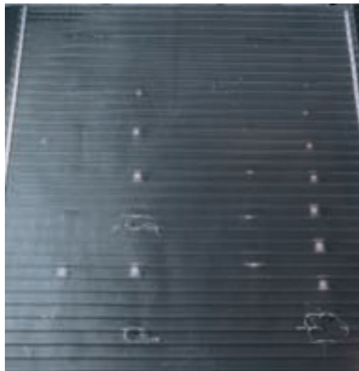
Abbildung 6.18: Stegdoppelplatte PMMA schlagzäh, Foto Empa.
