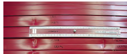
Verbiegung der Lamellen
