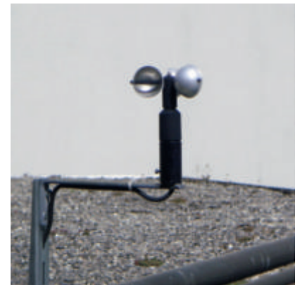
Windwächter. Bild: Gebäudeversicherung Graubünden
