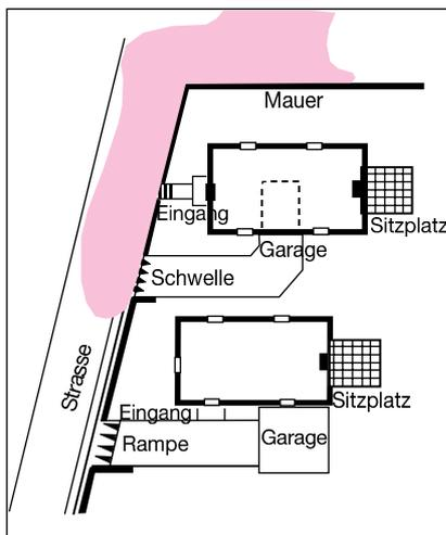
Mit Hilfe einer Ablenkmauer oder eines Ablenkdammes kann der Murgang in eine gewünschte Richtung umgelenkt werden. Ablenkbauwerke mit Ablenkwinkeln von  $20^\circ$  bis  $30^\circ$  können noch mit einem vertretbaren Aufwand erstellt werden. Sind die Umlenkwinkel grösser, so werden die erforderlichen Bauwerkshöhen gross und zudem ist das Abfliessen des Murganges nicht mehr gewährleistet.
